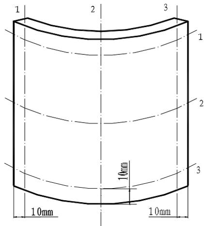
1, 2, 3—高度和直线度测量线 1', 2', 3'—线轮廓度测量线
