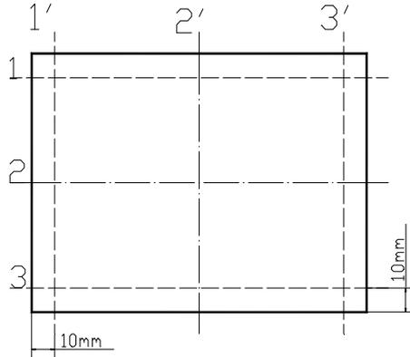
1, 2, 3—长度测量线；1', 2', 3'—宽度测量线
